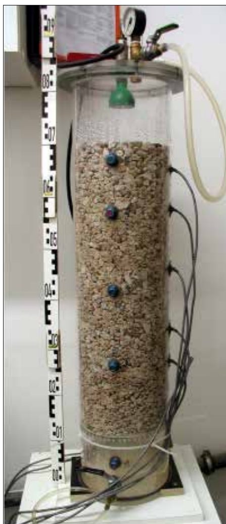
شکل ۱) ترکیب آزمایشی ضایعات AAC با MOB در یک ظرف شیشه‌ای هوازند و سیستم تخلیه برای کشت
