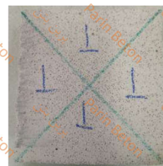
شکل ۱- هدف بتنی سبک هوادار اتوکلاو شده
