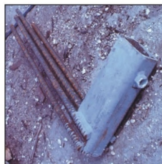
(ب) قوطلی فولادی جهت تکیه گاه اتکایی (دید از پایین)
