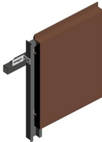
شکل ۸-۴- نمونه‌ای از روش اجرای هوک
