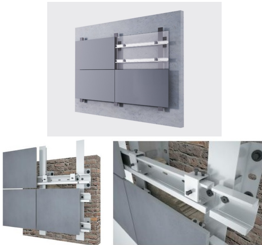
شکل ۷-۱۲- سیستم نصب پنهان با ایجاد مهار در پشت سرامیک
