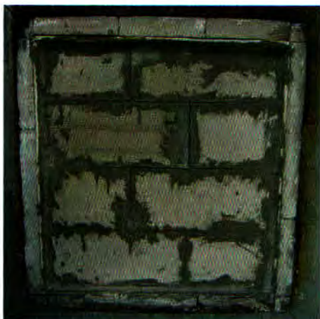
شکل ۷: وضعیت سمت در معرض نمونه پس از پایان آزمون
